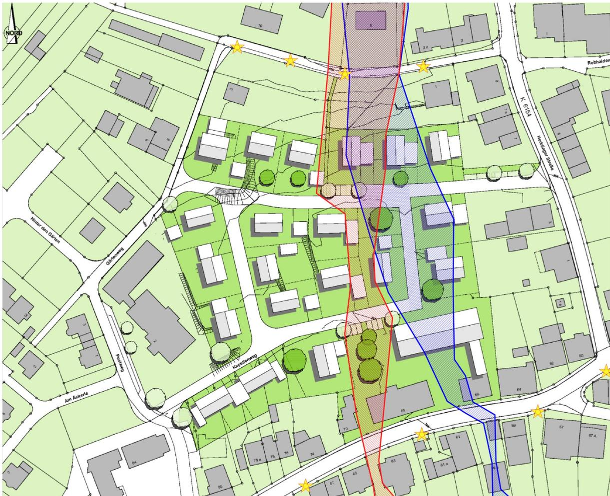
Abbildung 3: Bebauungsplan Variante 3 im Kontext mit dem Verlauf der bestehenden Flugstrasse (blau schraffiert) und einer möglichen Umleitung (rot schraffiert). Gelbe Sterne: Standorte von bestehenden Strassenleuchten
