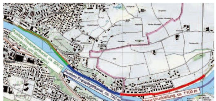
Druckleitung und Freispiegelkanal für Anschluss Büsingen
